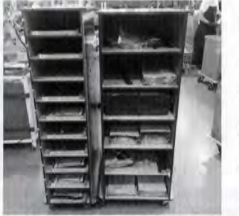
レーザー加工による合板での木質棚 ※用途に応じた使い分けを行っている
